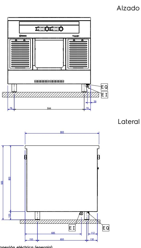
EI = Conexión eléctrica (energía)
